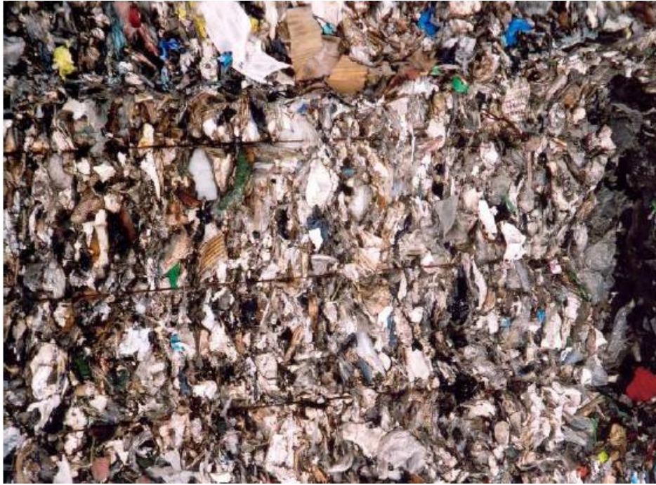
Fotografia zbelowanego paliwa w formie płatków uzyskanego z odpadów komunalnych [2]
